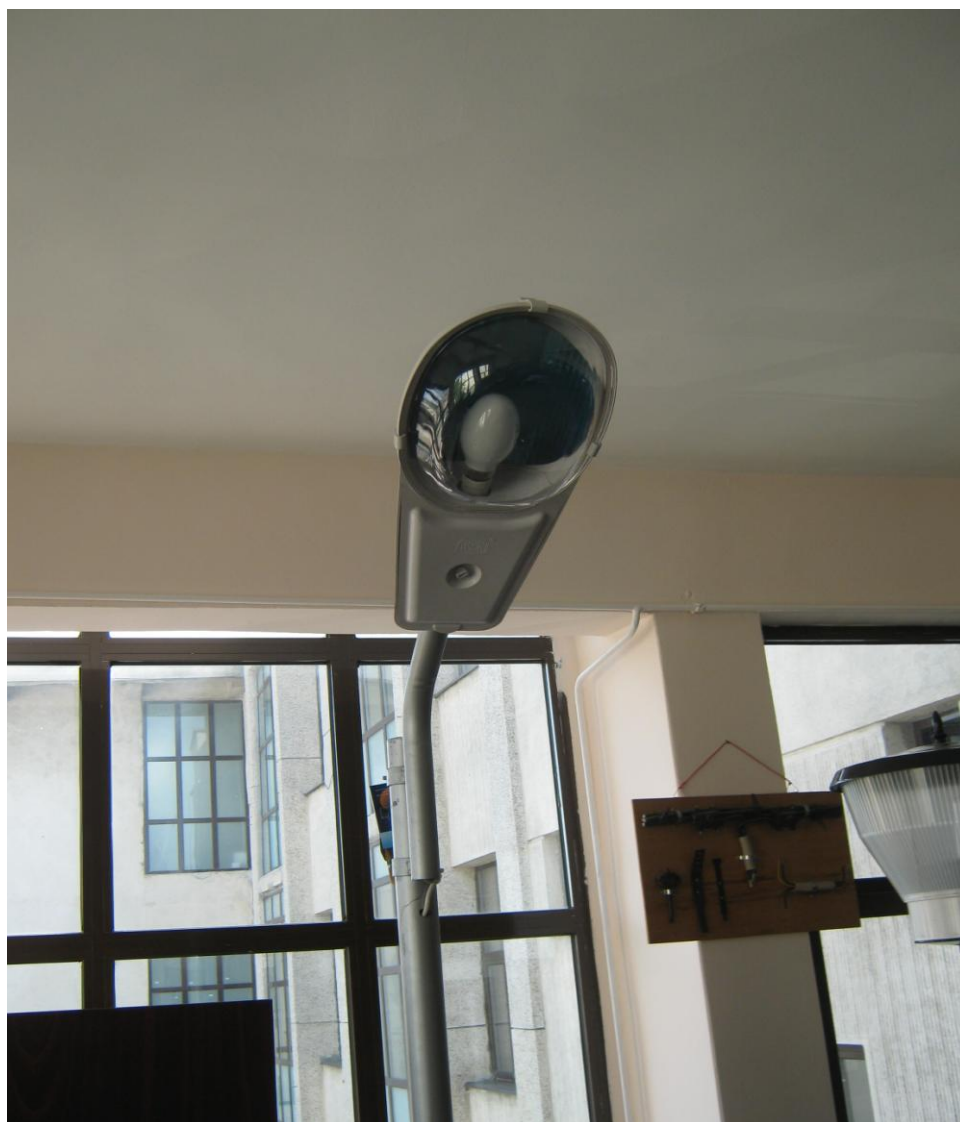
Figura 6 Vederea din față a corpului de iluminat de tip PVB, folosind ca sursă de iluminat lampă cu vapori de mercur
