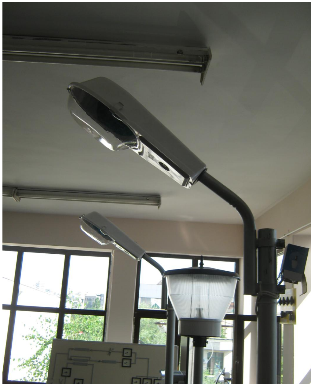
Figura 5 Vederea de ansamblu a modelului fizic de sistem pentru iluminatul public exterior
